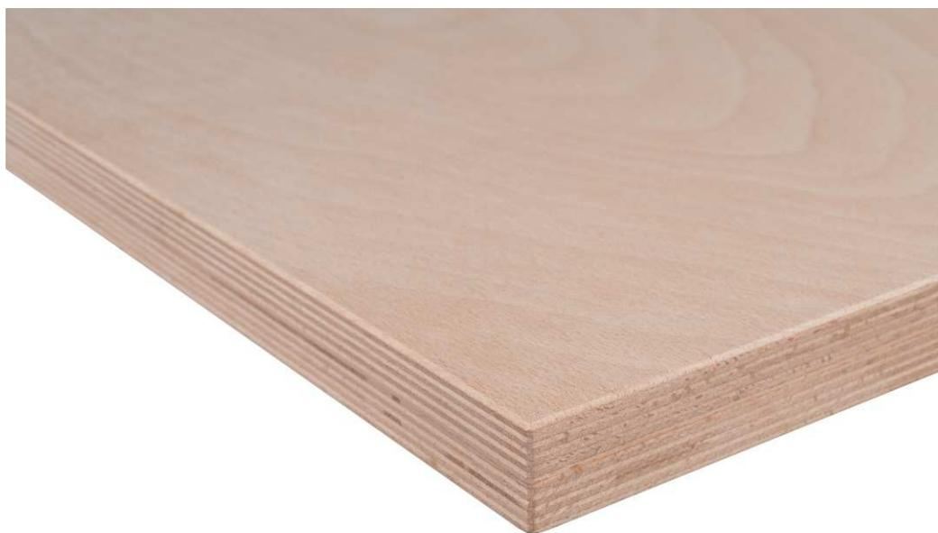
Panneaux constitués de plusieurs plis croisés de bois assemblés par collage sous haute pression. Dessus et chants poncés, arrêtes chanfreinées.
