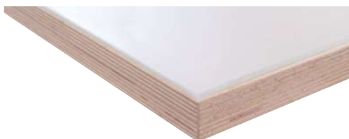
ÉTABLIS SI FIXES PLATEAU MULTIPLIS 40MM PEHD 5MM
